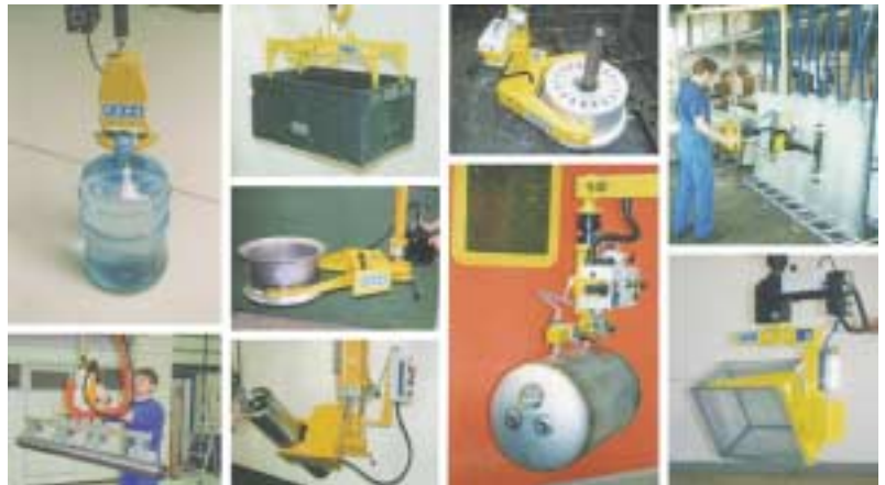
Bild 1: Lastaufnahmen sind die Kernstücke von Handhabungssystemen und werden für jeden Anwendungsfall individuell entwickelt
